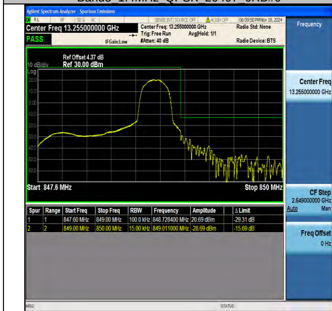
Band5 1.4MHz QPSK 20643 1RB#5
