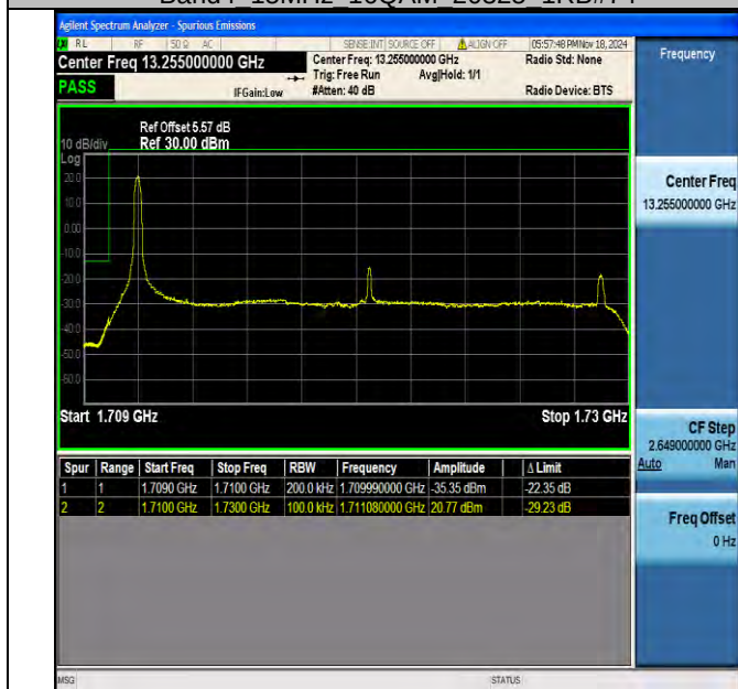
Band4 20MHz QPSK 20050 1RB#0
