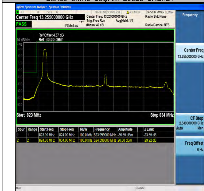
Band5 10MHz QPSK 20450 1RB#0
