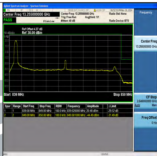
Band5 10MHz QPSK 20600 1RB#0
