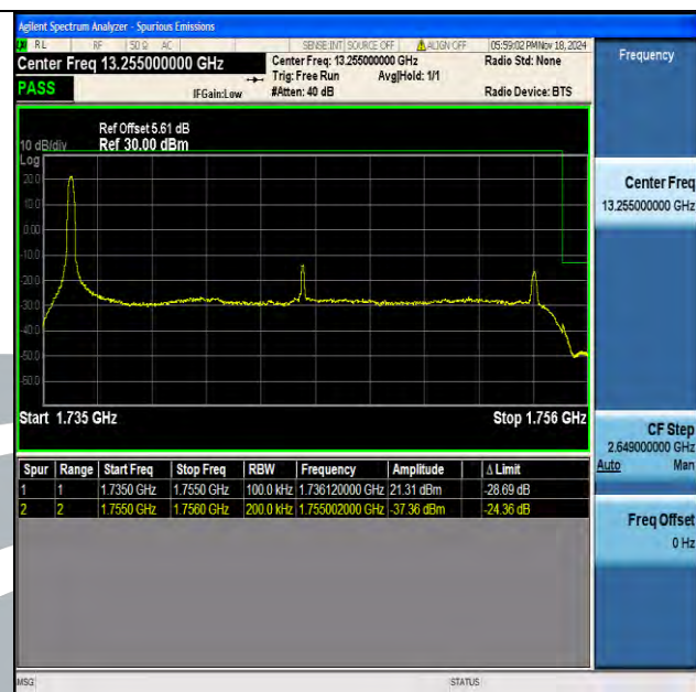
Band4 20MHz QPSK 20300 1RB#0
