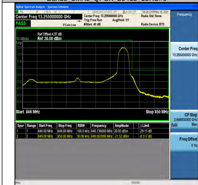
Band5 3MHz QPSK 20635 1RB#14
