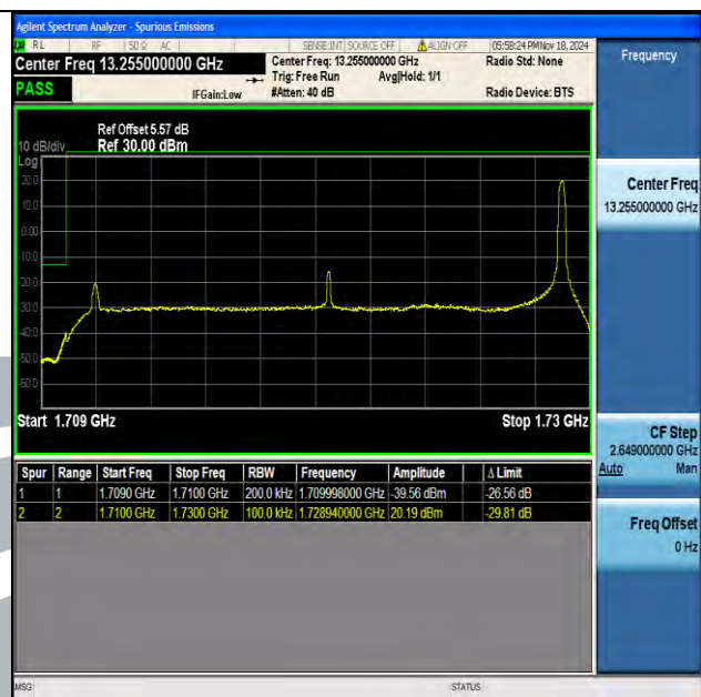
Band4 20MHz 16QAM 20050 1RB#99
