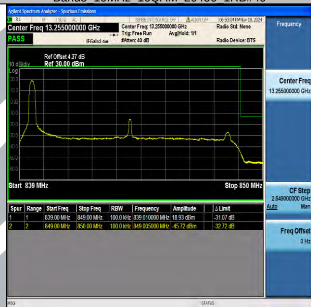
Band5 10MHz 16QAM 20600 1RB#0
