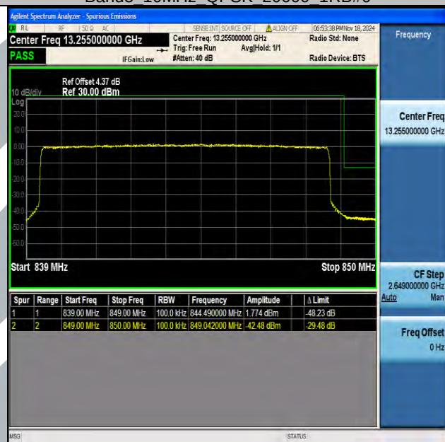
Band5 10MHz QPSK 20600 50RB#0
