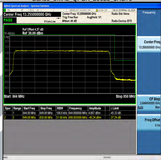
Band5 5MHz QPSK 20625 25RB#0
