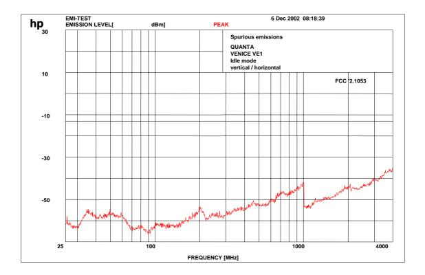
f < 1 GHz: RBW/VBW: 100 kHz $f \ge 1 \text{ GHz}: RBW/VBW: 1 \text{ MHz} (Peak)$
