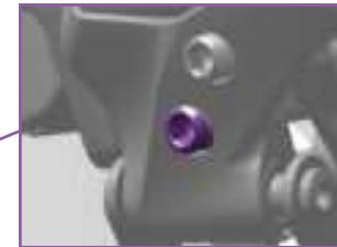
Réglez la vis de butée inférieure jusqu'à ce que l'espace entre l'intérieur de la plaque interne du dérailleur et la chaîne mesure de 0,5 à 1 mm.
