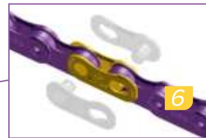
Puxe ambas as extremidades da corrente, juntando-as, e instale o PowerLock PLCK-D1. Comprima os elementos de ligação do PowerLock juntando-os.
