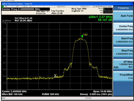
Test Plots without hopping ( $\pi/4DQPSK$ )
