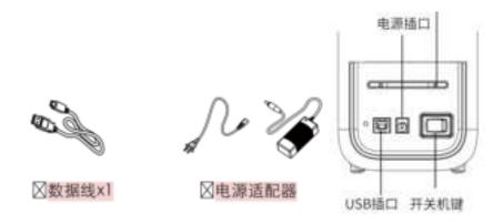
步骤 1.把电源线连接在电源适配器上,并插入机器背面的电源插口,另一端插入电源插座
