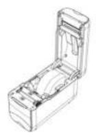
步骤3:打开夹纸板,并放入标签(标签打印面朝上)
