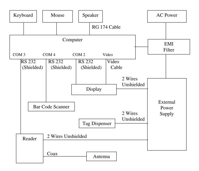
BLOCK DIAGRAM OF THE EQUIPMENT UNDER TEST
