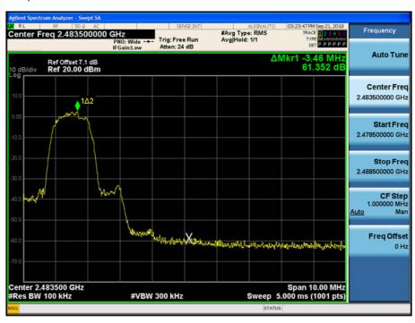
Test Plots without hopping ( $\pi/4DQPSK$ )
