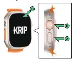
**Perilla (B):** Girar para interactuar con las aplicaciones. Toque una vez para volver a la pantalla de inicio. Toque dos veces para que aparezcan las funciones de llamada.
