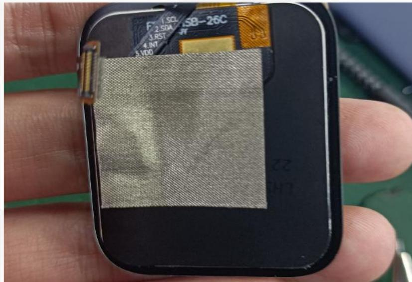
如图所示。用箭头标记的要用螺丝跟导电布接地，导电泡棉用于跟屏幕接地
