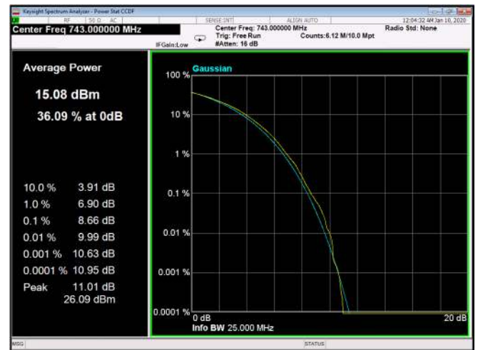
Figure 301: 256QAM 10MHz B.W.; 743.0MHz, 30kHz
