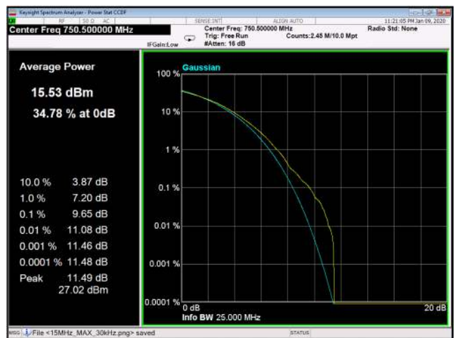
Figure 347: QPSK 15MHz B.W.; 750.5MHz, 60kHz
