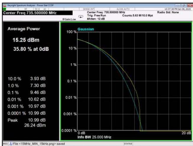
Figure 340: QPSK 15MHz B.W.; 735.5MHz, 30kHz
