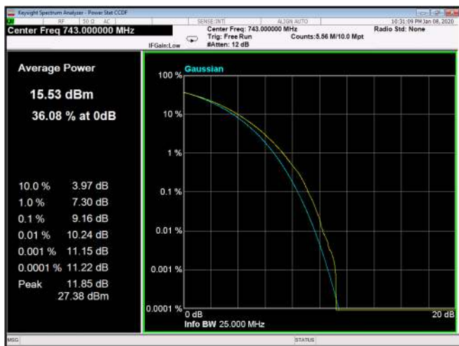
Figure 342: QPSK 15MHz B.W.; 743.0MHz, 15kHz
