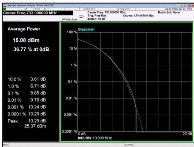
Figure 232: 16QAM 10MHz B.W.; 733.0MHz, 15kHz
