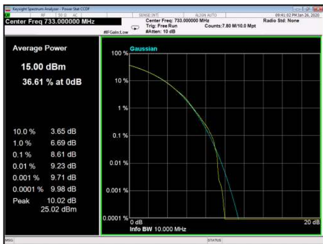
Figure 238: 16QAM 10MHz B.W.; 735.5MHz, 60kHz
