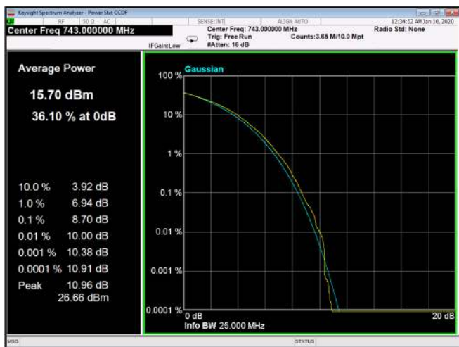
Figure 320: 256QAM 20MHz B.W.; 743.0MHz, 60kHz
