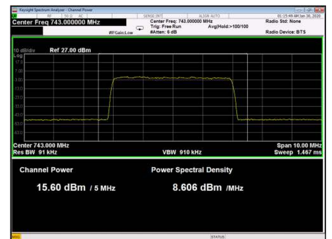
Figure 327: QPSK 5MHz B.W.; 743.0MHz, 30kHz
