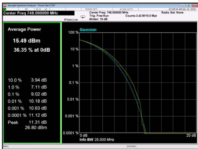
Figure 288: 64QAM 20MHz B.W.; 748.0MHz, 15kHz
