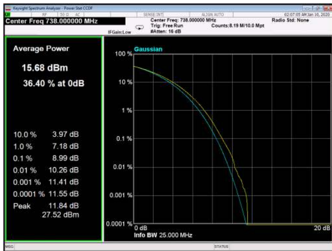
Figure 282: 64QAM 20MHz B.W.; 738.0MHz, 15kHz
