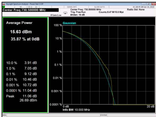
Figure 258: 64QAM 5MHz B.W.; 730.5MHz, 15kHz
