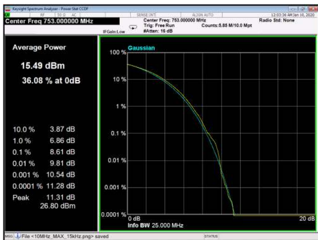
Figure 304: 256QAM 10MHz B.W.; 753.0MHz, 30kHz
