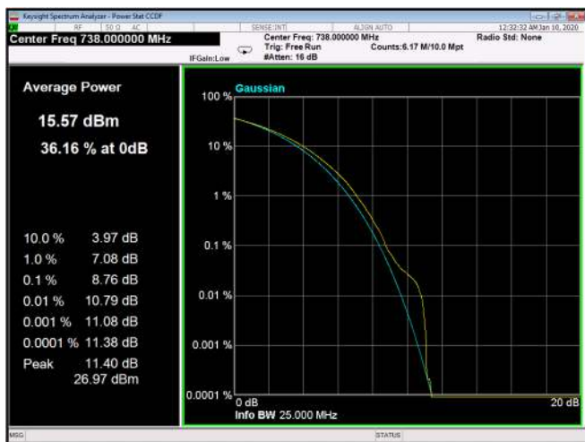
Figure 316: 256QAM 20MHz B.W.; 738.0MHz, 30kHz
