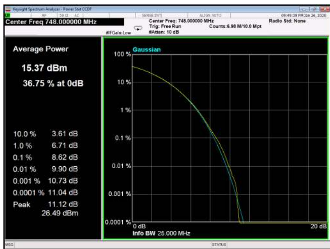
Figure 252: 16QAM 20MHz B.W.; 748.0MHz, 15kHz
