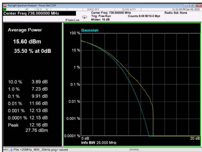
Figure 350: QPSK 20MHz B.W.; 738.0MHz, 60kHz
