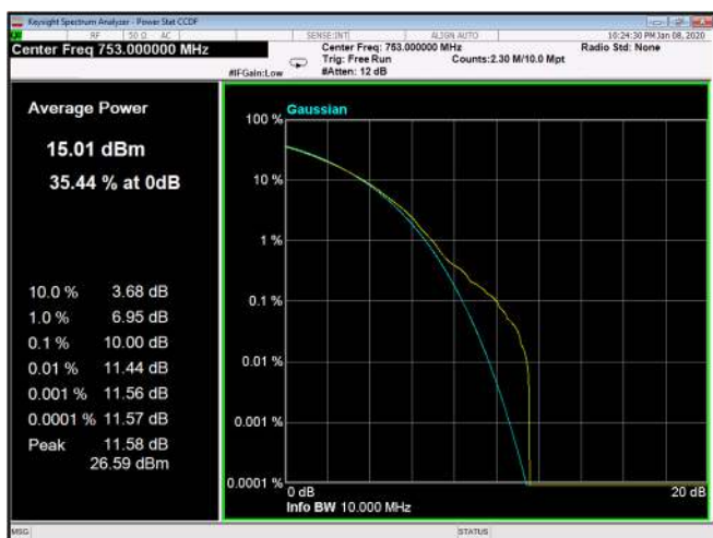
Figure 338: QPSK 10MHz B.W.; 753.0MHz, 60kHz
