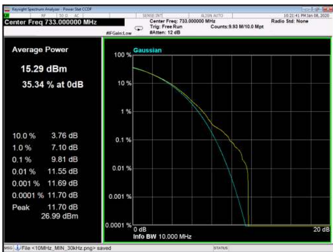
Figure 332: QPSK 10MHz B.W.; 733.0MHz, 60kHz
