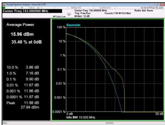
Figure 334: QPSK 10MHz B.W.; 743.0MHz, 30kHz
