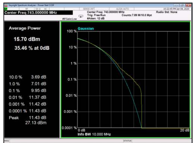
Figure 335: QPSK 10MHz B.W.; 743.0MHz, 60kHz
