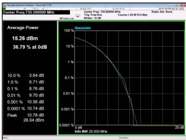
Figure 244: 16QAM 15MHz B.W.; 735.5MHz, 30kHz
