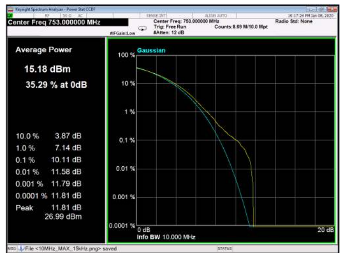
Figure 337: QPSK 10MHz B.W.; 753.0MHz, 30kHz
