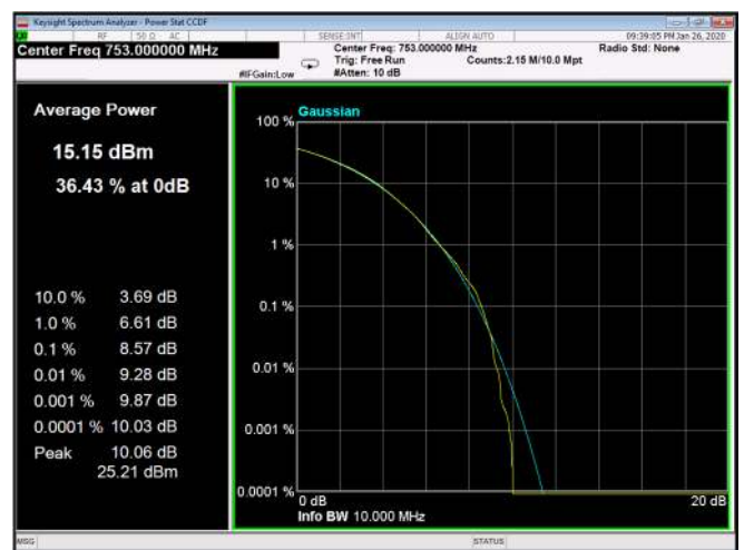
Figure 237: 16QAM 10MHz B.W.; 753.0MHz, 30kHz
