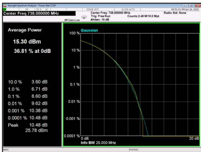
Figure 250: 16QAM 20MHz B.W.; 738.0MHz, 15kHz
