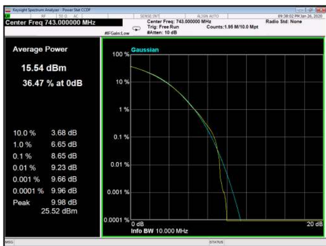
Figure 236: 16QAM 10MHz B.W.; 743.0MHz, 30kHz
