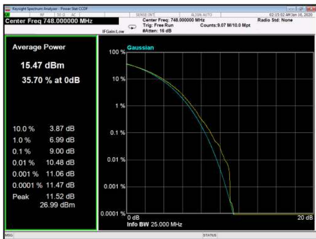
Figure 290: 64QAM 20MHz B.W.; 748.0MHz, 60kHz
