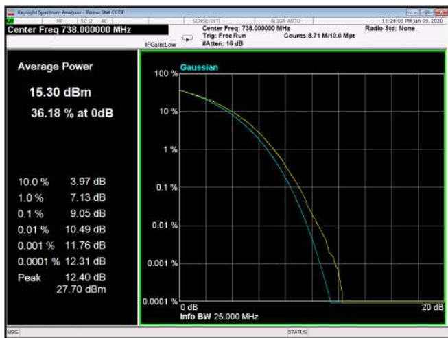
Figure 348: QPSK 20MHz B.W.; 738.0MHz, 15kHz
