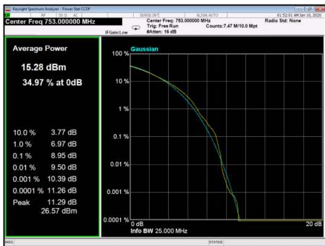
Figure 272: 64QAM 10MHz B.W.; 753.0MHz, 60kHz
