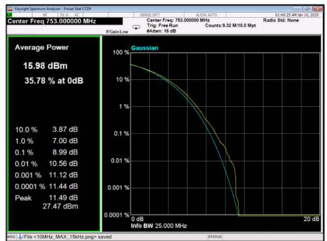
Figure 271: 64QAM 10MHz B.W.; 753.0MHz, 30kHz
