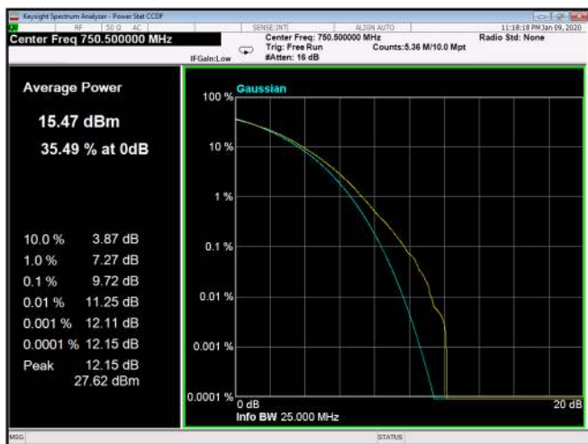
Figure 346: QPSK 15MHz B.W.; 750.5MHz, 30kHz
