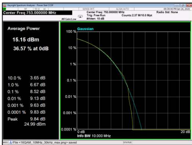
Figure 240: 16QAM 10MHz B.W.; 753.5MHz, 60kHz
