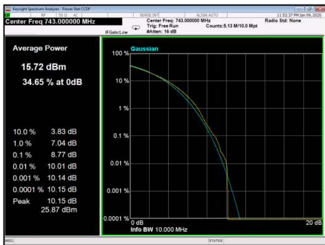
Figure 294: 256QAM 5MHz B.W.; 743.0MHz, 30kHz
