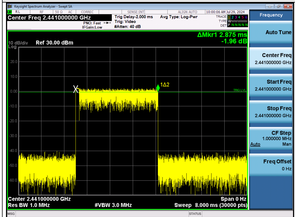
Test_Graph_EDR_HOP_ANT1_NA_3Mbps_2441_Time per Burst
