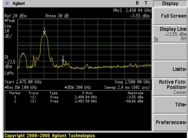
$\pi$  /4-DQPSK: Band Edge-Low Channel
