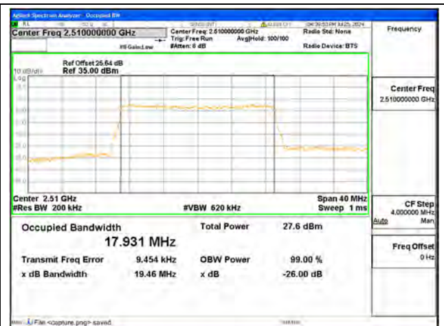
B7 / 20MHz / 16QAM/ Low CH
