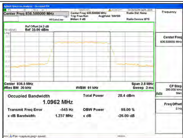
B5 / 1.4MHz / QPSK/ Mid CH
