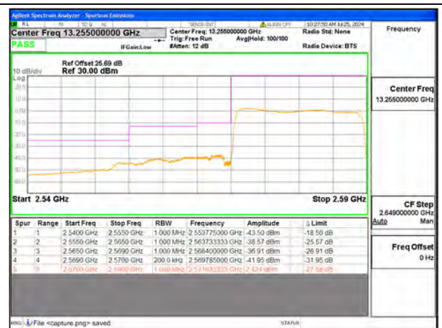
B38 / 20MHz / Low CH / QPSK / FULL RB
