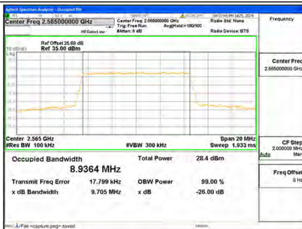
B7 / 10MHz / QPSK/ High CH
