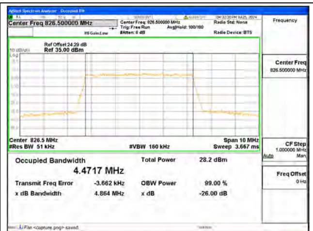
B5 / 5MHz / 16QAM/ Low CH
