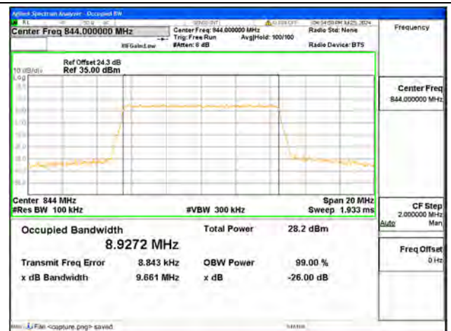
B5 / 10MHz / 16QAM/ High CH
