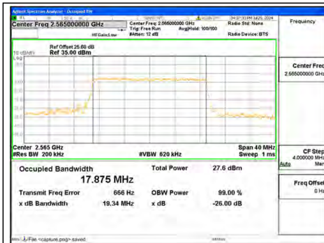
B41 / 20MHz / QPSK/ Low CH
