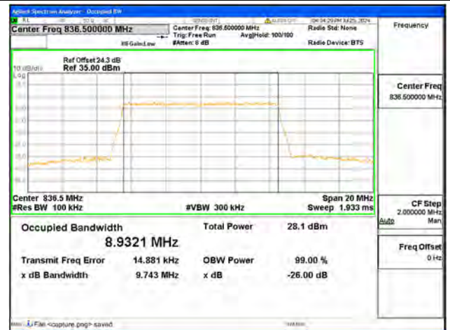
B5 / 10MHz / 16QAM/ Mid CH
