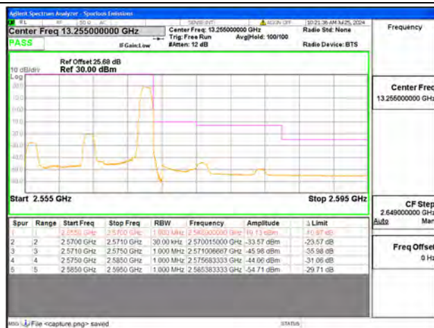
B7 / 15MHz / High CH / QPSK / 1 RB
