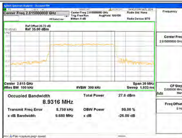
B38 / 10MHz / QPSK/ High CH
