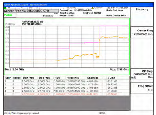
B38 / 10MHz / Low CH / QPSK / FULL RB
