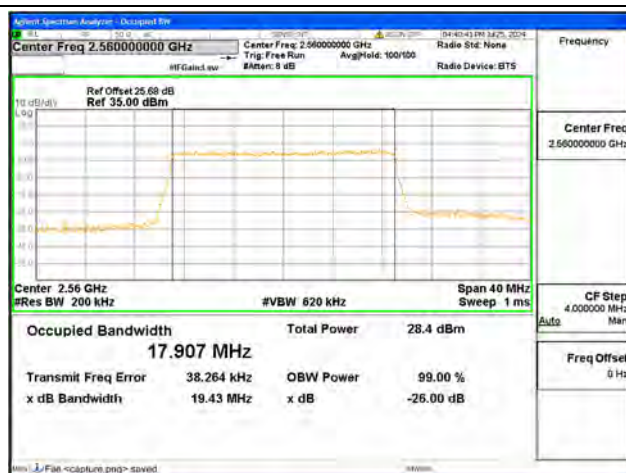
B7 / 20MHz / QPSK/ High CH
