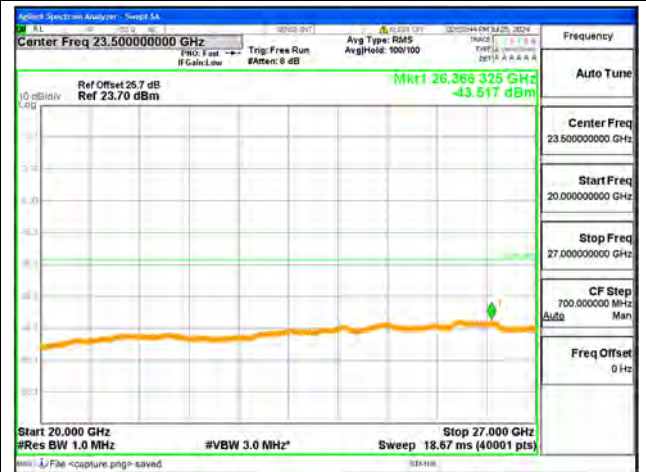
B38-20G-27G / 10MHz / Mid CH / QPSK
