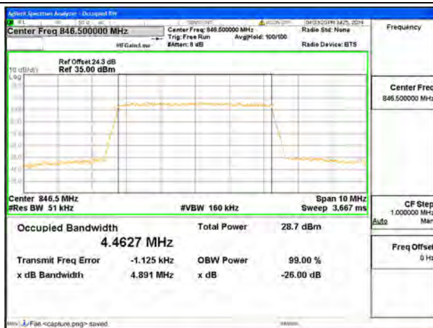
B5 / 5MHz / QPSK/ High CH
