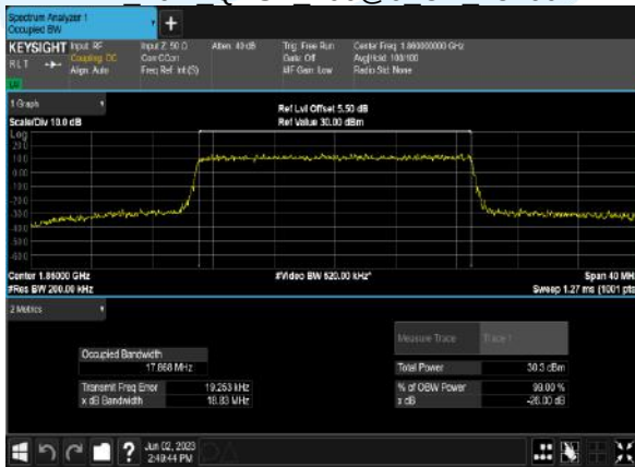
B2 20M QPSK 100@0 CH 18700
