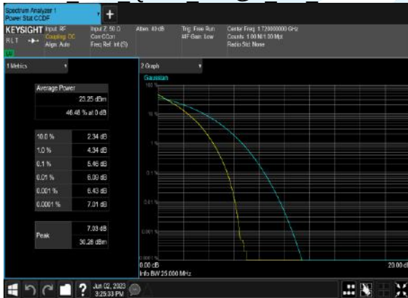
B4 20M QPSK 100@0 CH 20050
