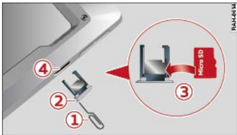
Fig. 28 Dos de l'Audi tablet : changement de la carte micro SD
