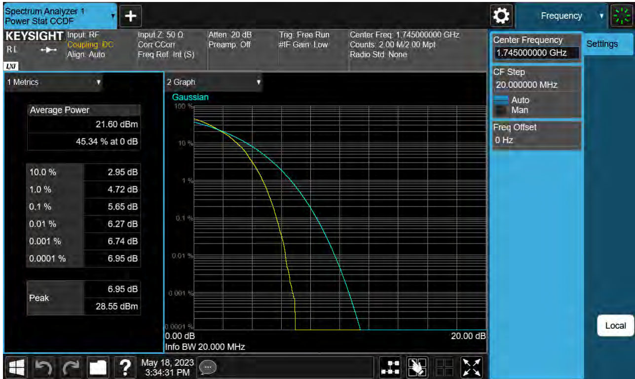
Sub6 n66. PAR Plot (20 M BW_Ch.349000_64QAM_Full RB)
