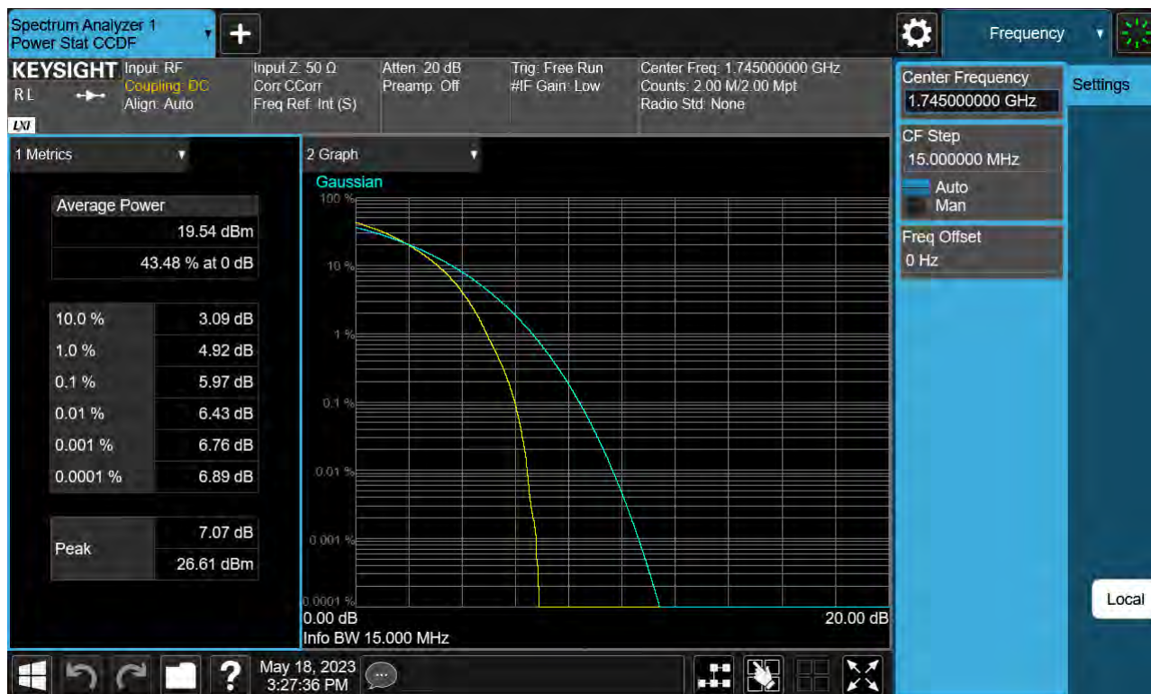
Sub6 n66. PAR Plot (15 M BW_Ch.349000_256QAM_Full RB)
