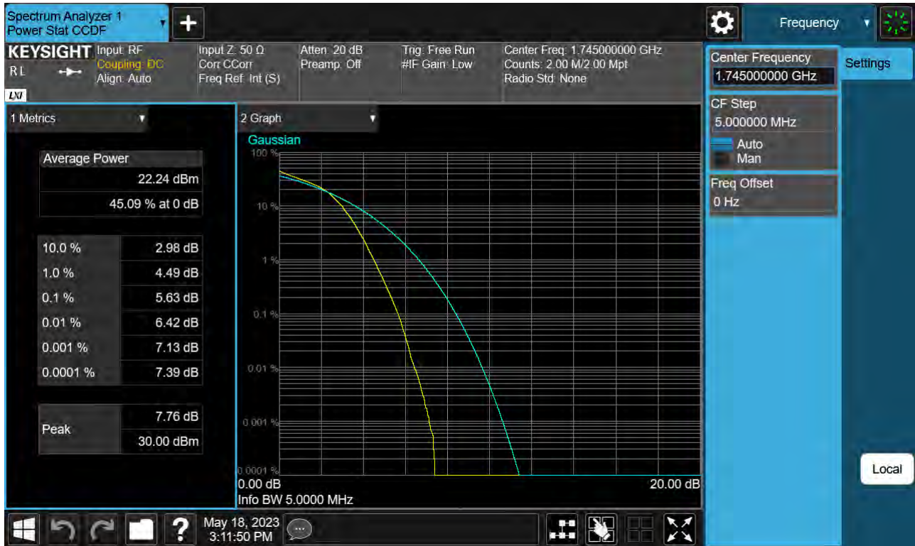
Sub6 n66. PAR Plot (5 M BW_Ch.349000_16QAM_Full RB)
