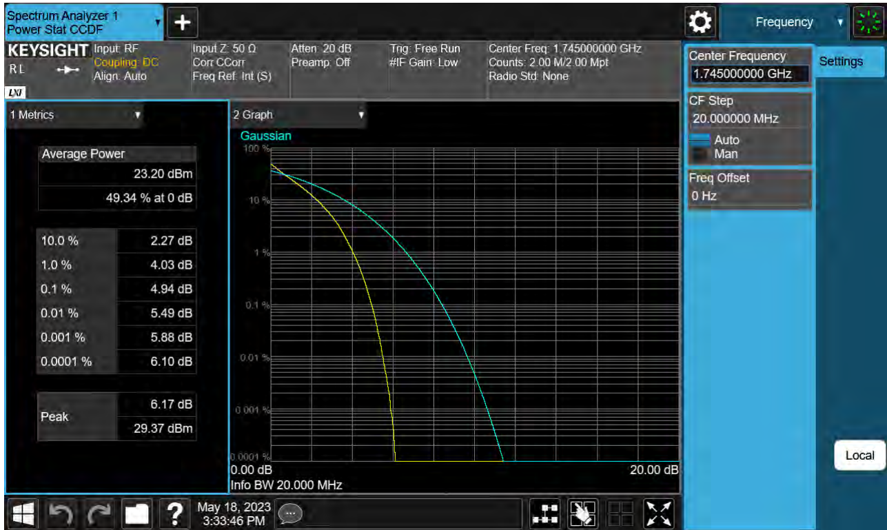
Sub6 n66. PAR Plot (20 M BW_Ch.349000_QPSK_Full RB)
