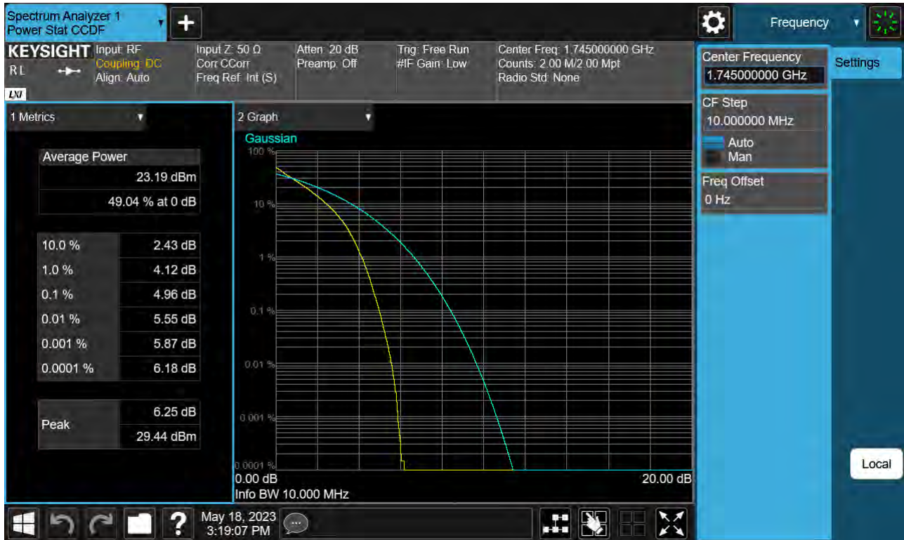
Sub6 n66. PAR Plot (10 M BW_Ch.349000_QPSK_Full RB)
