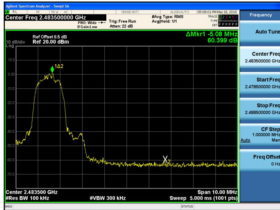
Test Plots without hopping ( $\pi/4$ DQPSK)
