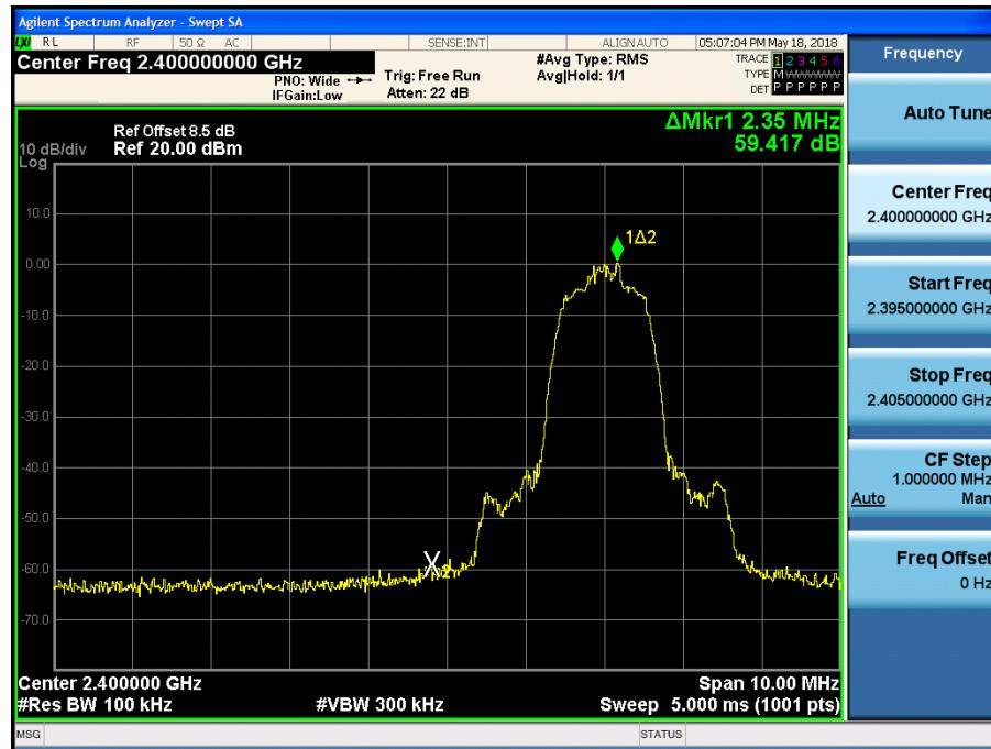
Test Plots without hopping ( $\pi/4$ DQPSK)
