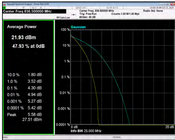
n26(824-849) SCS=15kHz DFT_BPSK BW=20MHz Channel=167300 RB=100@0
