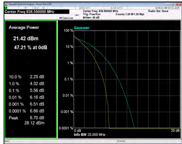
n26(824-849) SCS=15kHz DFT_QPSK BW=20MHz Channel=167300 RB=100@0
