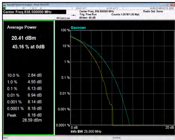
n26(824-849) SCS=15kHz DFT_16QAM BW=20MHz Channel=167300 RB=100@0
