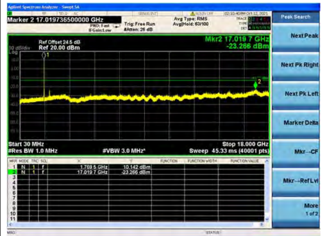
Band66 / 20MHz / Low CH / QPSK
