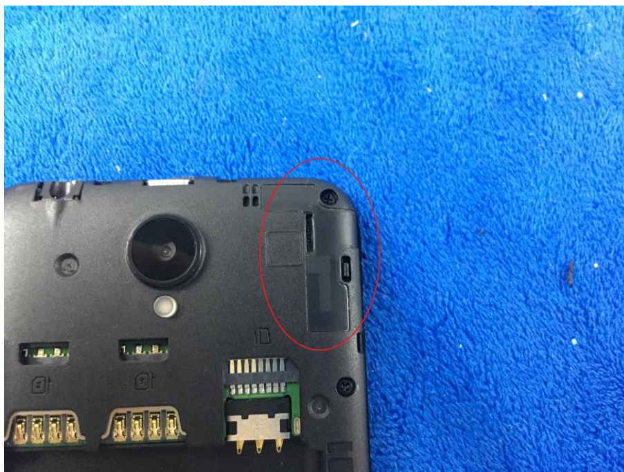
BT/WIFI/BLE/GPS - Antenna View
