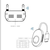
1. 请按住接收器功能键3秒钟以上, 界面弹出提示语: Release the button to pair with EZCast TX。等待发射器进入配
