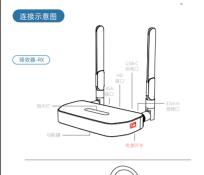
1. 将接收器的HD口或VGA口连接到显示器或电视等显示设 备的视频输入口。 2. 将接收器的USB-C供电口连接充电线,插入电源适配器
