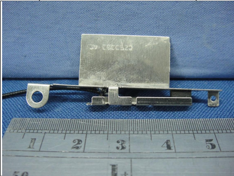
Antenna set 1 (Chain 0 / Brand : WNC, Model : 81-EBJ15.005)
