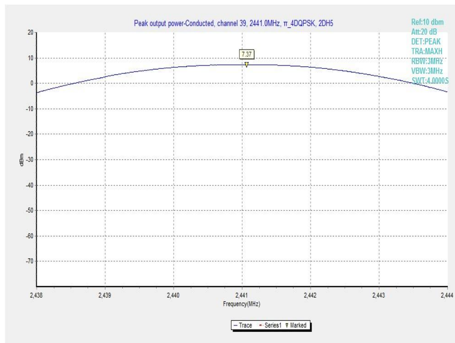
Fig. 5 Maximum Peak Output Power( \pi/4 DQPSK, Ch 39)
