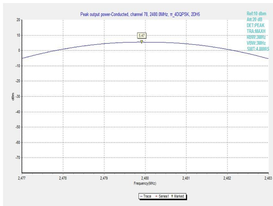
Fig. 6 Maximum Peak Output Power( \pi/4 DQPSK, Ch 78)
