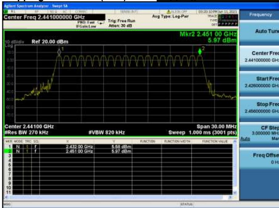
Number of Hopping Channels 1(AFH) Hopping mode : Enable & $\pi/4$ DQPSK
