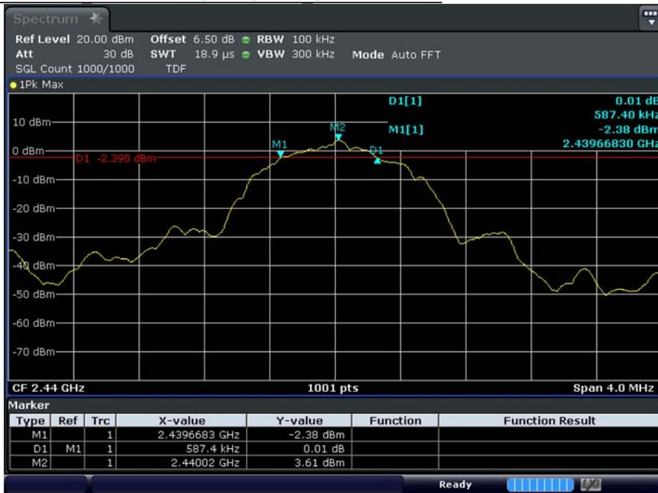
Test mode : SLAVE Bluetooth LE / 2 480 MHz 6 dB Bandwidth
