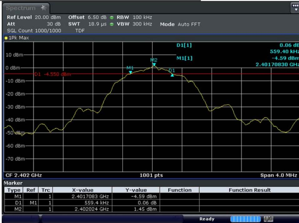
Test mode : SLAVE Bluetooth LE / 2 440 MHz 6 dB Bandwidth
