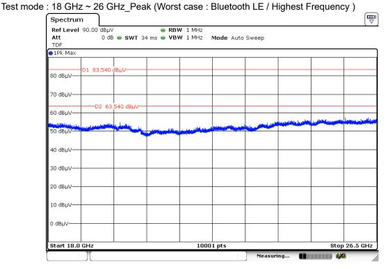
Note 1 : Measured distance : 1 m Note 2 : Limit : Peak : 83.5 dBµV/m
