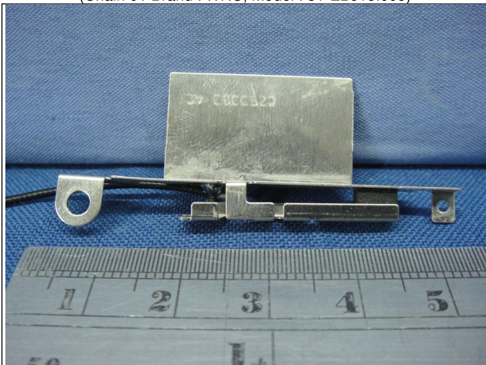
Antenna set 1 (Chain 0 / Brand : WNC, Model : 81-EBJ15.005)
