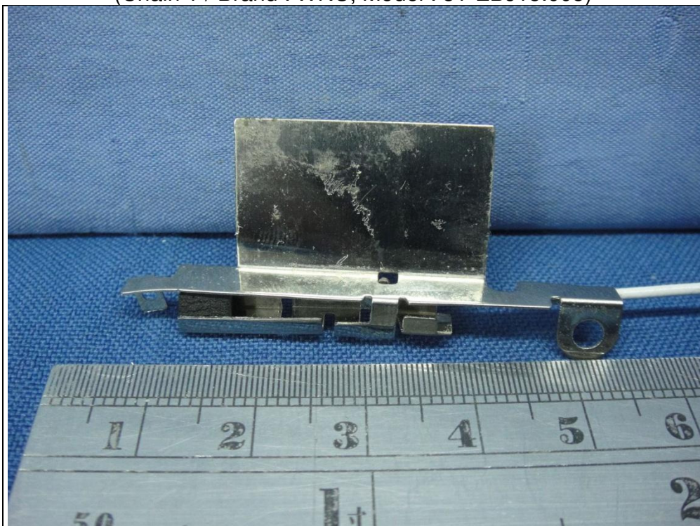
Antenna set 1 (Chain 1 / Brand : WNC, Model : 81-EBJ15.005)
