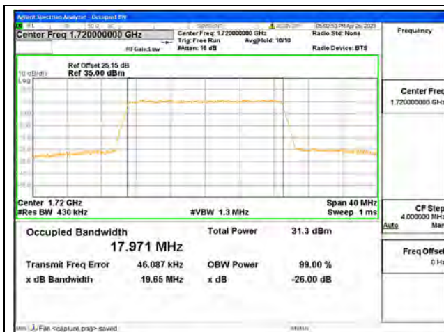
Band4 / 20MHz / QPSK/ Low CH
