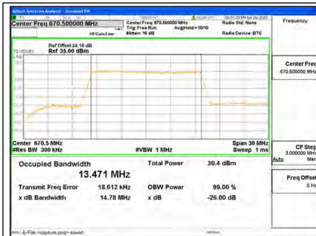
Band71 / 15MHz / QPSK/ Low CH
