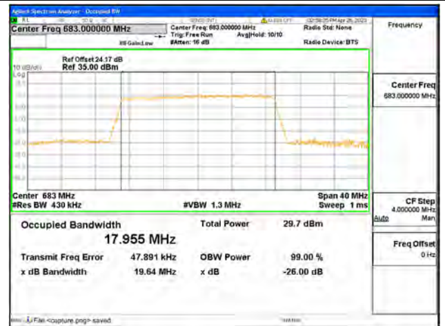
Band71 / 20MHz / 16QAM/ Mid CH
