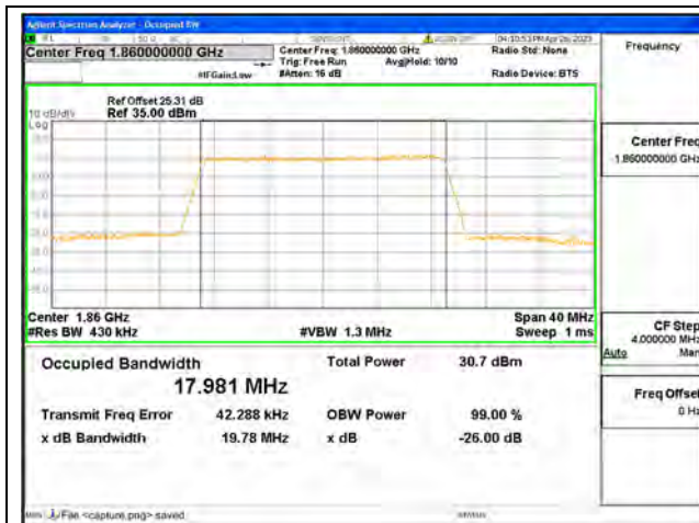
Band2 / 20MHz / QPSK/ Low CH
