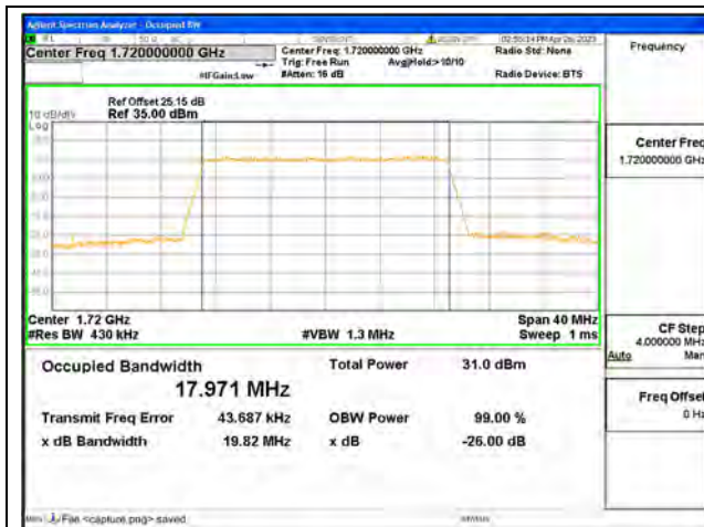
Band66 / 20MHz / QPSK/ Low CH
