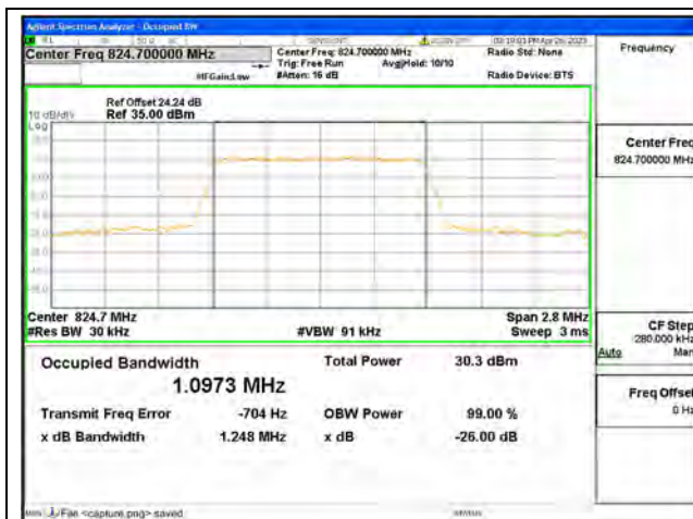
Band5 / 1.4MHz / QPSK/ Low CH
