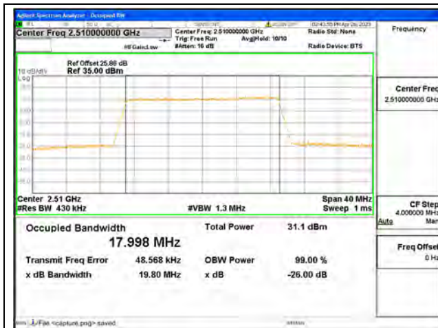
Band7 / 20MHz / QPSK/ Low CH
