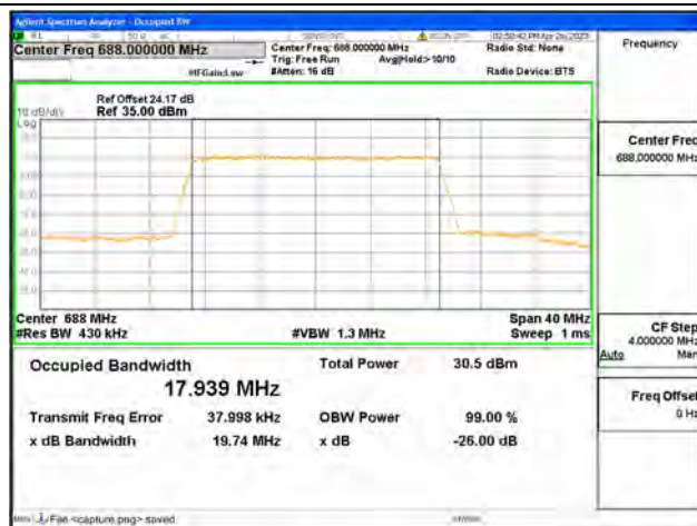
Band71 / 20MHz / QPSK/ High CH
