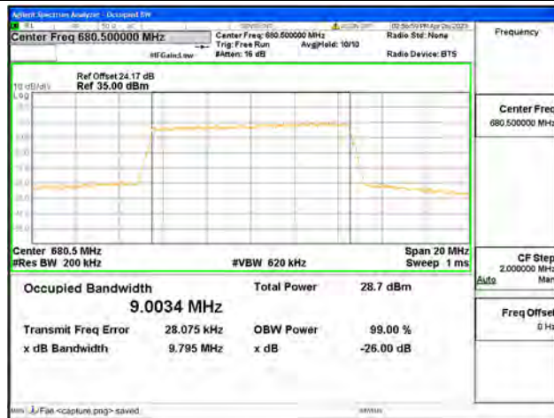
Band71 / 10MHz / QPSK/ Mid CH
