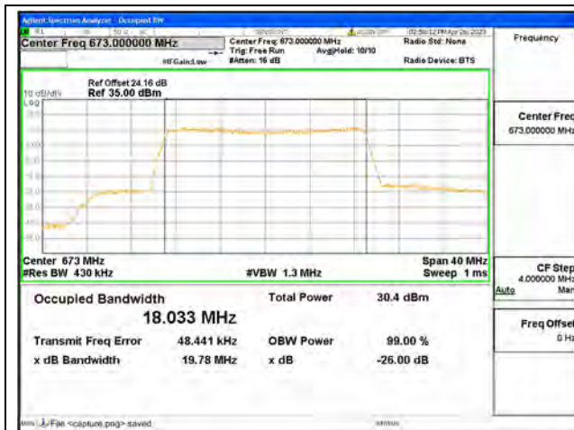
Band71 / 20MHz / QPSK/ Low CH
