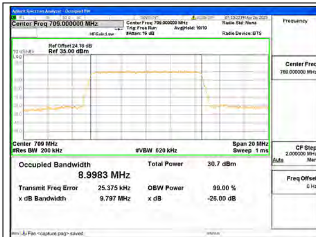
Band17 / 10MHz / QPSK/ Low CH
