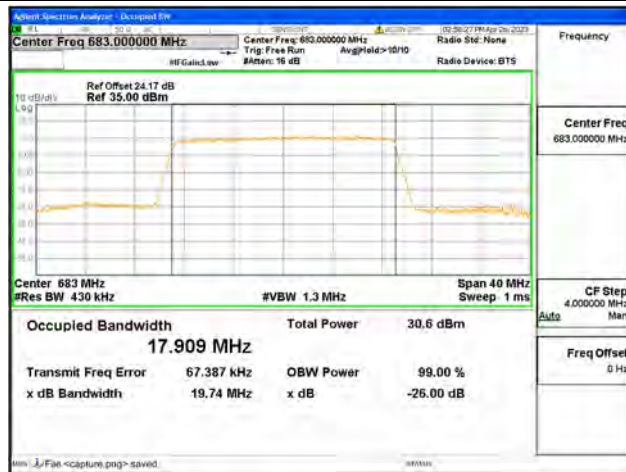
Band71 / 20MHz / QPSK/ Mid CH
