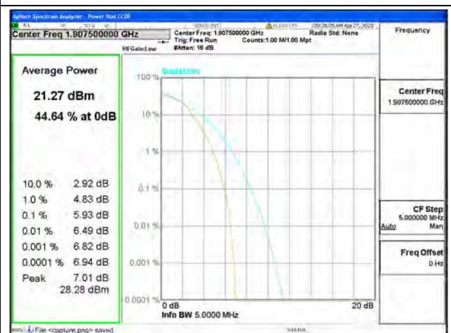
Band2 / 5MHz / High CH / 16QAM
