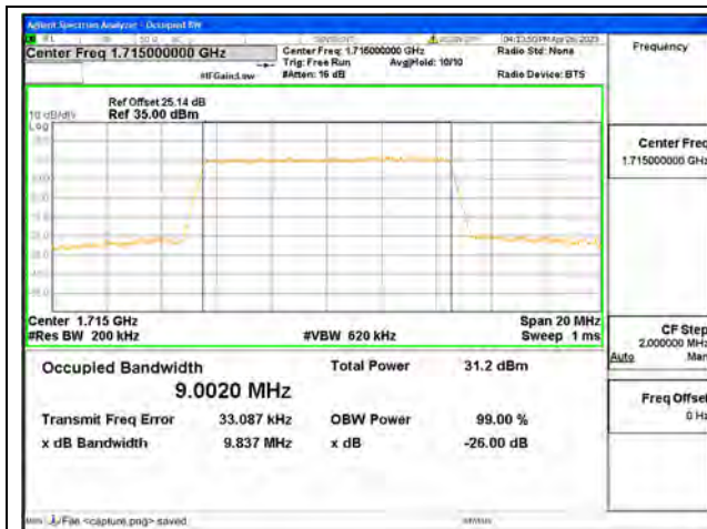
Band4 / 10MHz / QPSK/ Low CH
