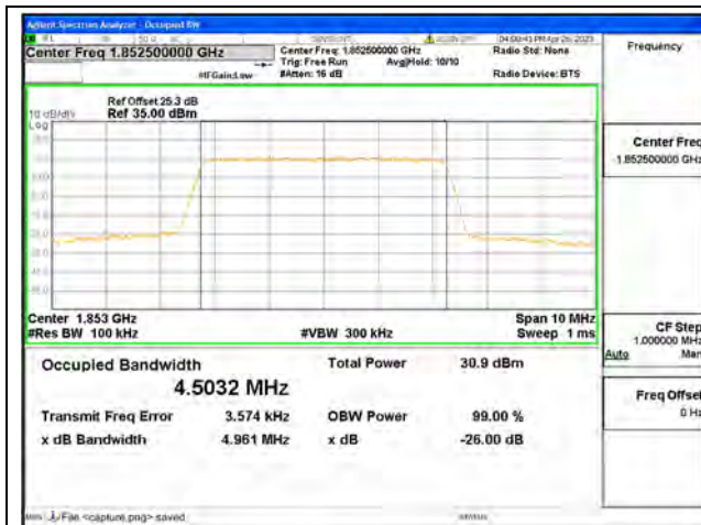
Band2 / 5MHz / QPSK/ Low CH
