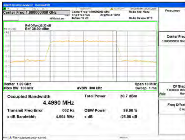
Band2 / 5MHz / QPSK/ Mid CH
