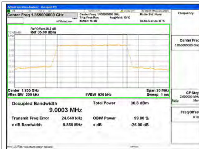
Band2 / 10MHz / QPSK/ Low CH
