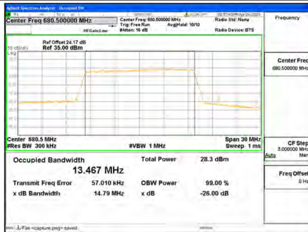
Band71 / 15MHz / QPSK/ Mid CH
