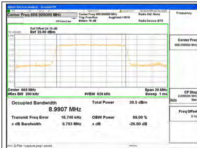
Band71 / 10MHz / QPSK/ Low CH
