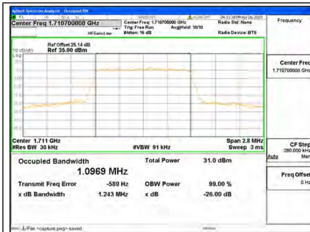
Band4 / 1.4MHz / QPSK/ Low CH
