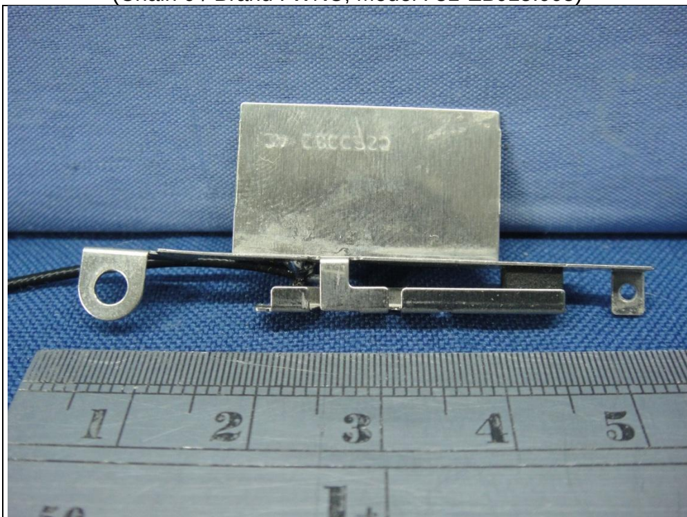
Antenna set 1 (Chain 0 / Brand : WNC, Model : 81-EBJ15.005)
