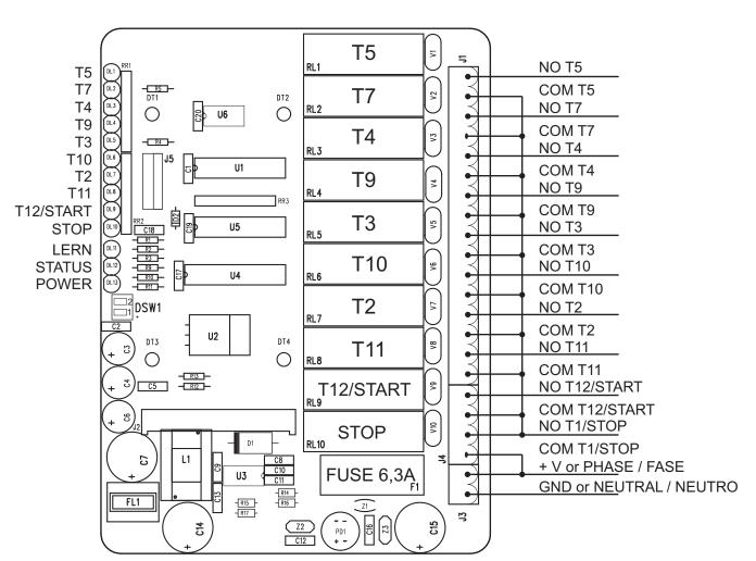
Relay T12/START is activated pressing T8 (Alarm) on the transmitter. Il relè T12/START si attiva alla pressione di T8 (Allarme) sul trasmettitore.
