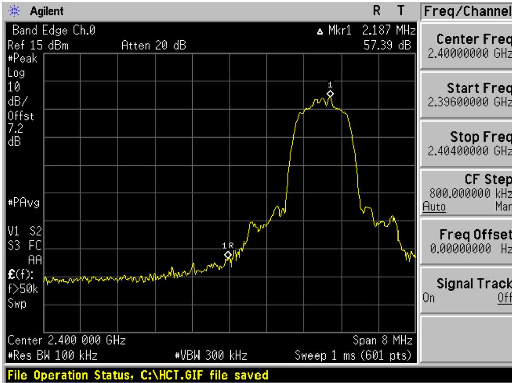
Test Plots without hopping ( $\pi/4$ DQPSK)
