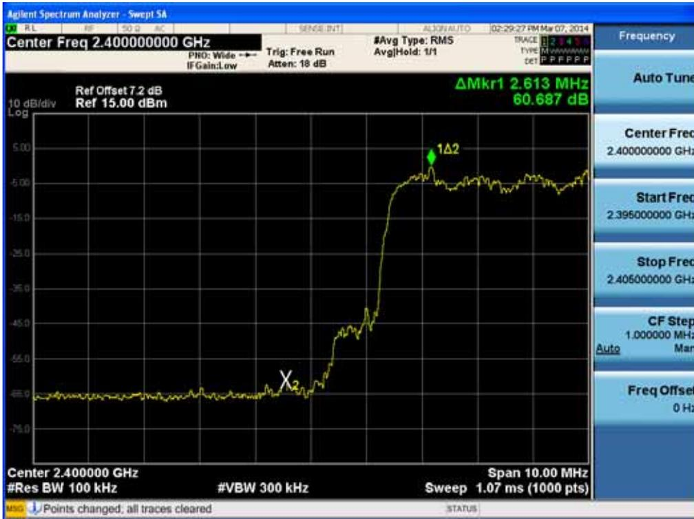
Test Plots with hopping ( $\pi/4$ DQPSK)
