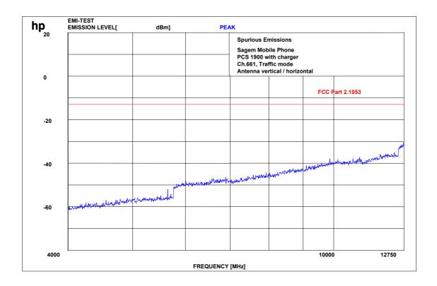
f < 1 GHz : RBW/VBW : 100 kHz  $f \ge 1 \text{GHz} : \text{RBW/VBW} 1 \text{ MHz}$
