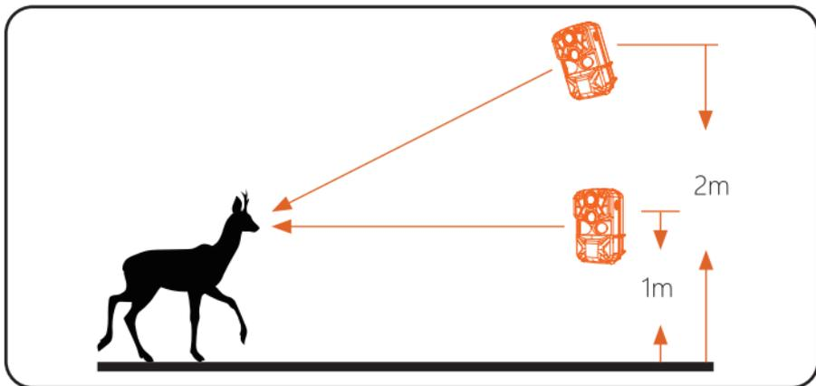
1. Der Erfassungsbereich des Sensors beträgt  $120^\circ$ . Bitte richten Sie den Hauptsensor auf den zu fotografierenden Bereich, um sicherzustellen, dass kein Motiv verpasst wird.
