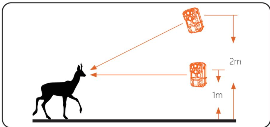
1. La plage de détection du capteur est de  $120^\circ$ . Veuillez orienter le capteur principal vers la zone à photographier afin de vous assurer qu'aucun sujet ne sera manqué.
