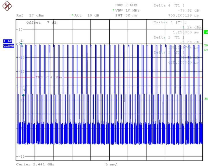
Fig.59 Number of Transmissions Measurement: Ch39, Packet DH1
