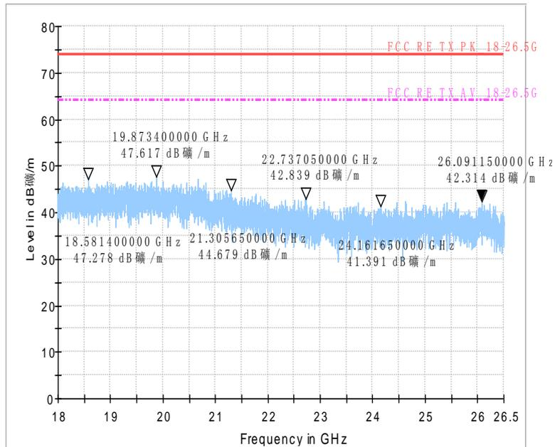
Fig.51 Radiated emission:  $\pi/4$  DQPSK, 18 GHz - 26 GHz
