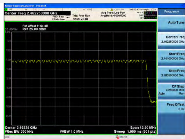
\pi/4 -DQPSK 2.4415 GHz ~ 2.4835 GHz
