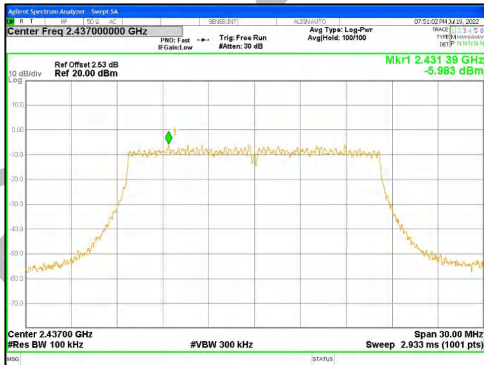
PSD NVNT g 2462MHz Ant1
