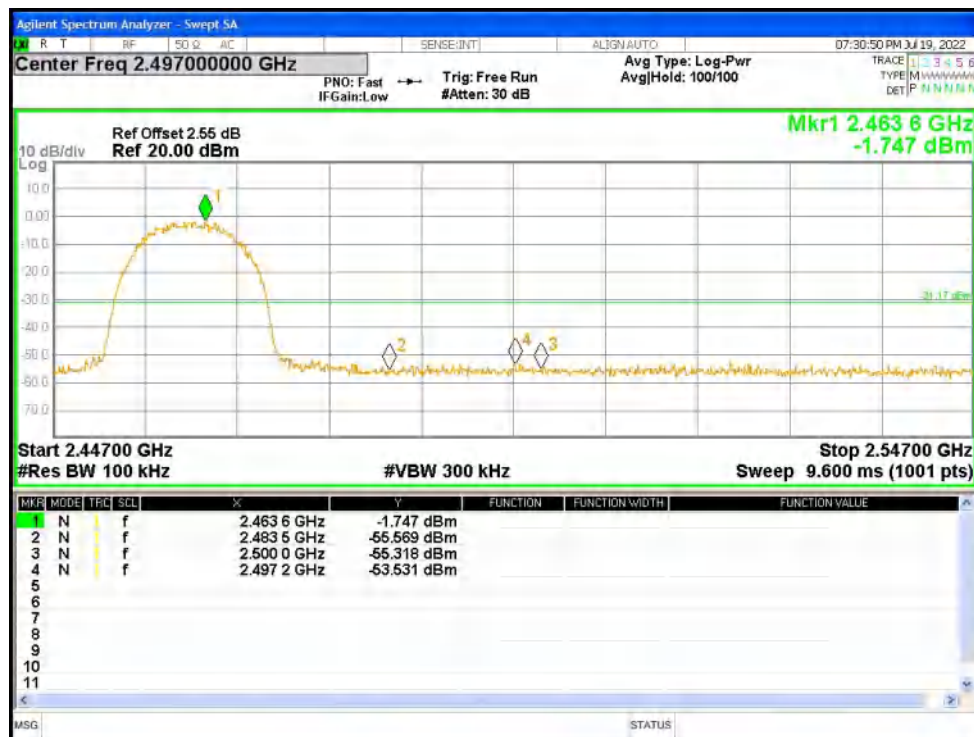
Band Edge NVNT g 2412MHz Ant1 Ref
