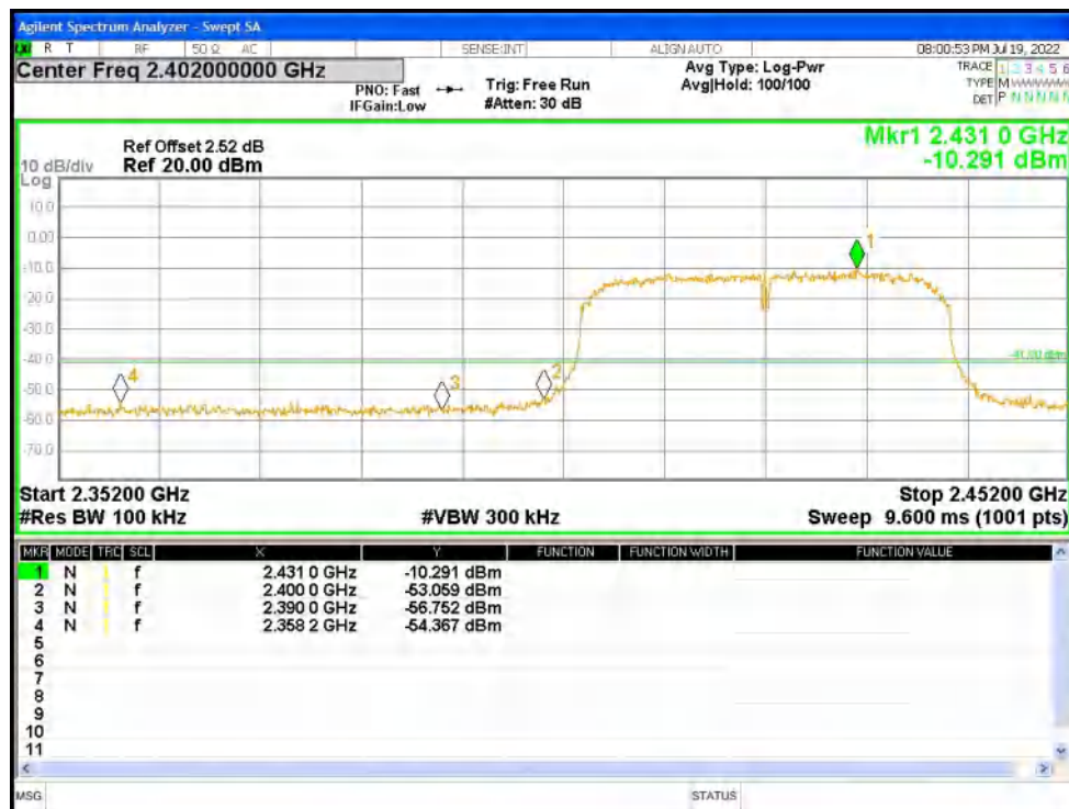
Band Edge NVNT n40 2452MHz Ant1 Ref
