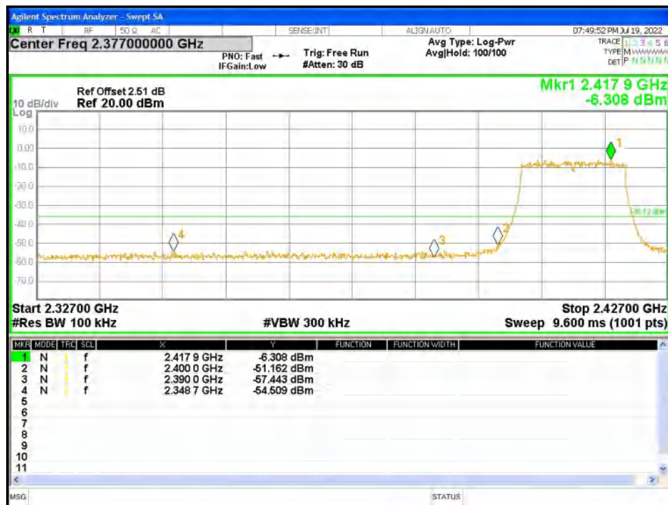
Band Edge NVNT g 2462MHz Ant1 Ref
