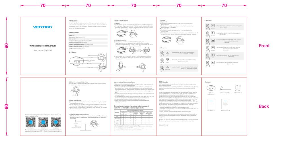
成品尺寸: 70x90mm 展开尺寸: 350x90mm 材质: 157g哑粉纸 5页 风琴折 双面印刷
