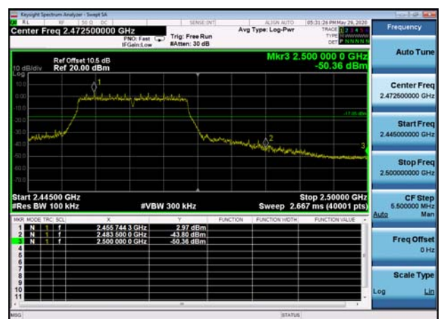
,Plot 2,Band Edge-802.11n(HT20) ,2462MHz,Ant0
