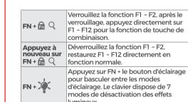
Appuyez brièvement sur le bouton d'éclairage pour changer la luminosité quatre niveaux de luminosité.
