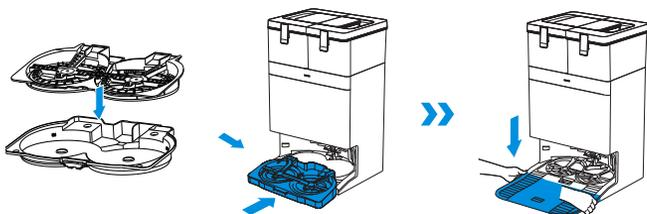
**Nota:** Instale la bandeja de lavado de las mopas correctamente para evitar problemas de funcionamiento.
