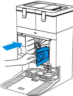
3. Coloque las juntas de ajuste en el borde superior de la cubierta del compartimento de polvo y presione la parte inferior de la misma para instalarla correctamente.
