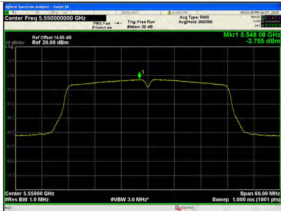
PSD NVNT ac40 5550MHz Ant0 SISO
