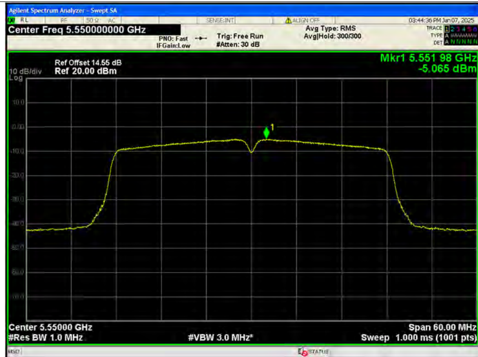
PSD NVNT n40 5550MHz Ant1 MIMO
