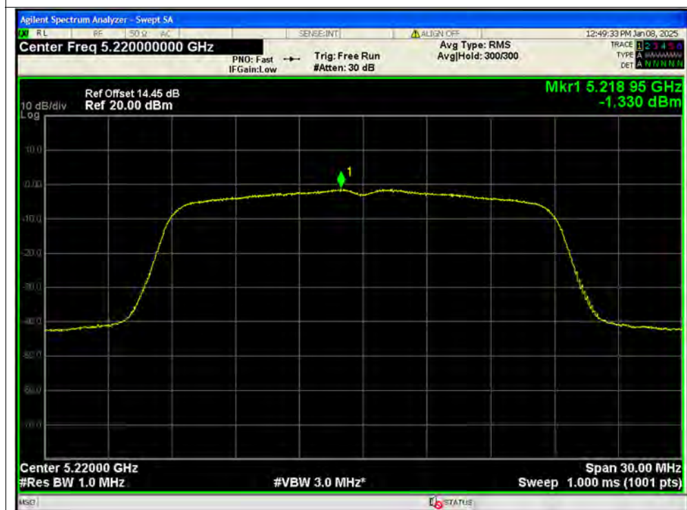
PSD NVNT ac20 5220MHz Ant1 SISO
