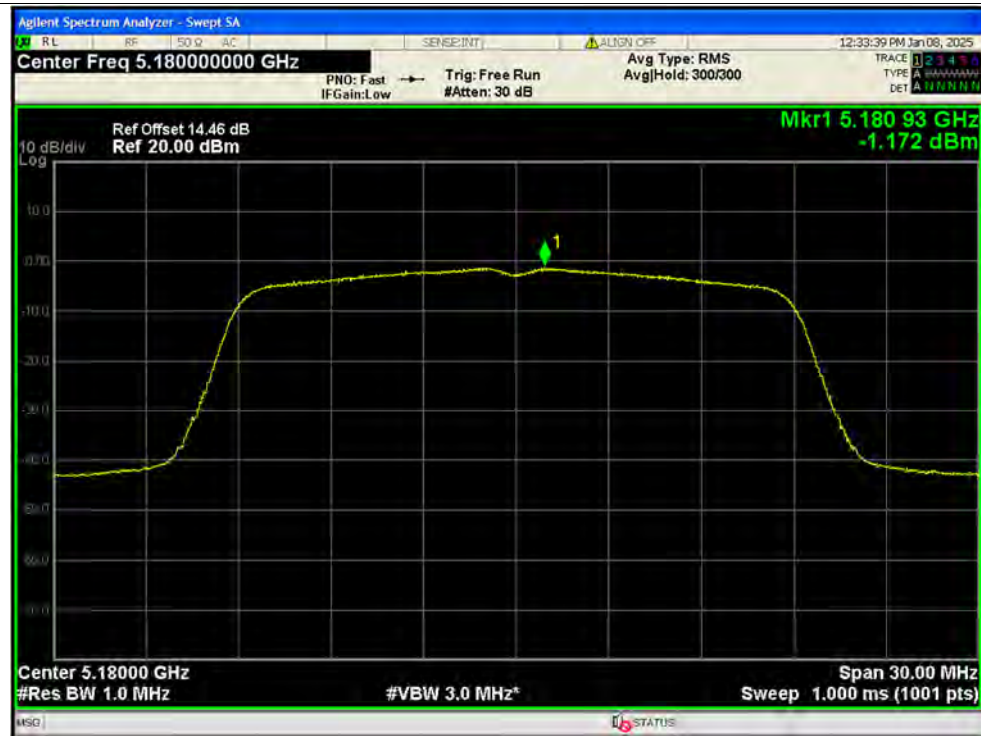
PSD NVNT ac20 5220MHz Ant0 SISO
