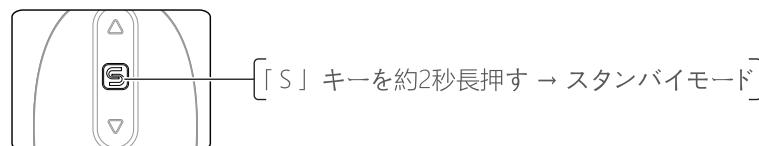
ご注意: リモコンで操作する際（まずはローターをオンにしなければなりません。）「S」キー約2秒長押ししますとスタンバイモードに入れります（30分以内に操作なしの場合に、ローターは自動的にオフになります。）任意のボタンを押しますと、再び振動できます。
