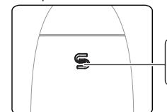
Cambiar el modo de vibración Haga doble clic en la tecla "S"
