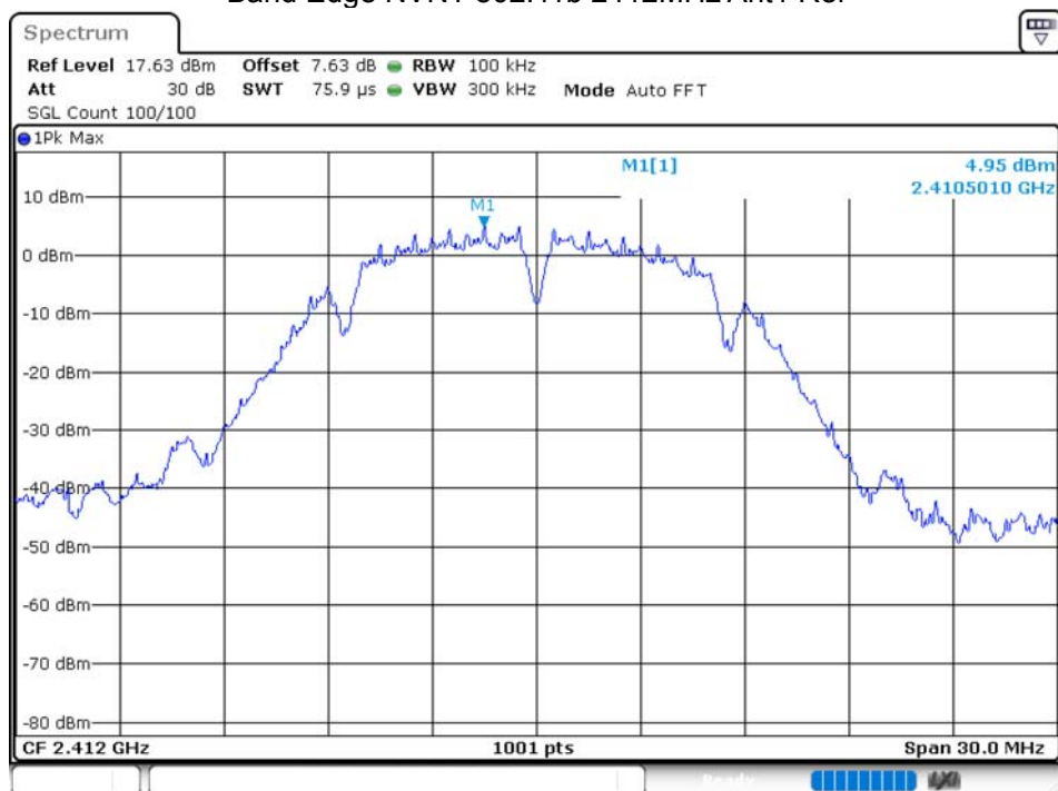
Band Edge NVNT 802.11b 2412MHz Ant1 Ref
