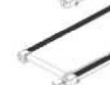
2. Al correr la corredera se inclina hacia la derecha, ajustando el tornillo a la derecha 1-2 vueltas en el sentido de las agujas del reloj. Luego, pruebe la operación; si aún se inclina hacia el lado derecho, repita los pasos anteriores hasta volver al centro.
