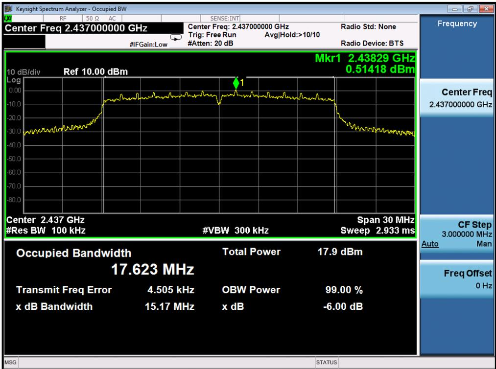
TEST PLOT OF BANDWIDTH FOR HIGH CHANNEL
