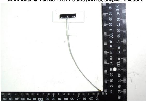
WLAN Antenna (Part No.: H2B1PC1A1C (AA258), Supplier: Unictron)
