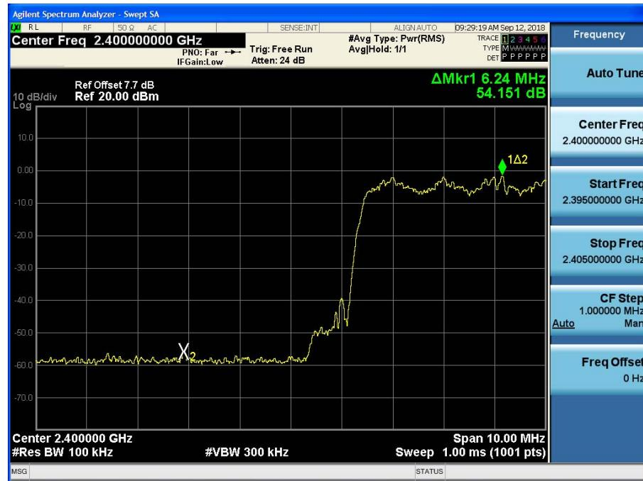
Test Plots with hopping ( $\pi/4$ DQPSK)
