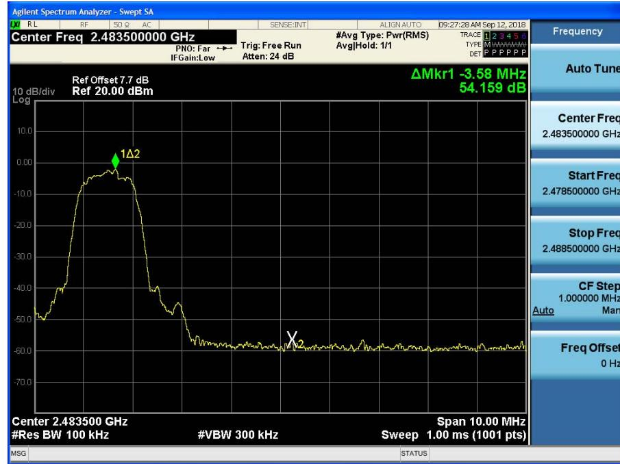
Test Plots without hopping ( $\pi/4$ DQPSK)
