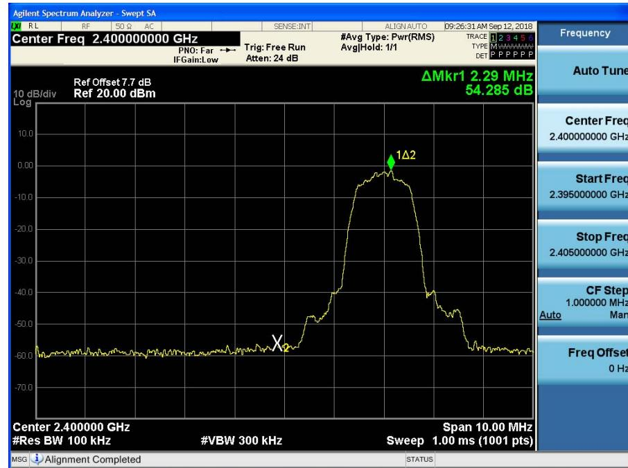
Test Plots without hopping ( $\pi/4$ DQPSK)
