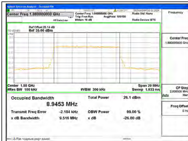
B2 / 10MHz / QPSK/ Mid CH
