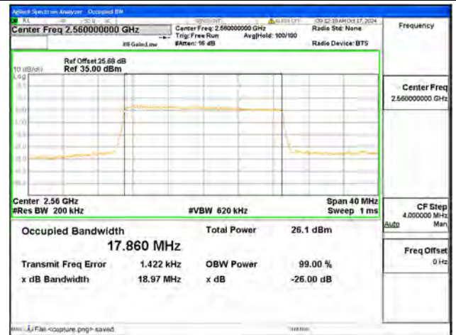
B7 / 20MHz / QPSK/ High CH
