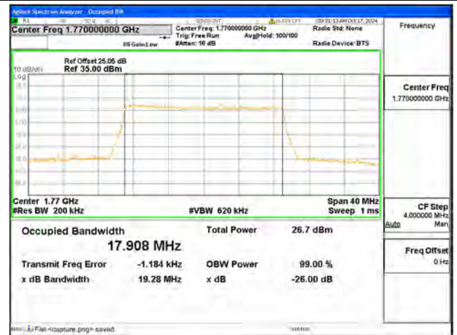
B66 / 20MHz / QPSK/ High CH
