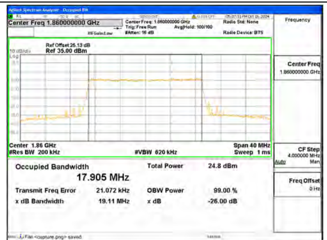
B2 / 20MHz / 64QAM/ Low CH
