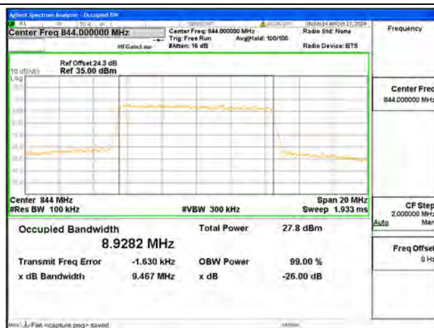
B5 / 10MHz / 16QAM/ High CH
