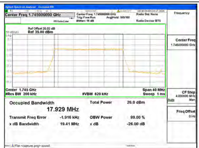
B66 / 20MHz / 16QAM/ Mid CH
