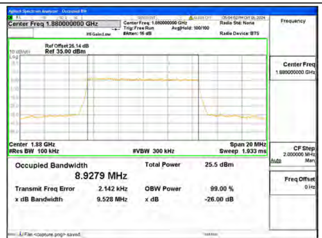
B2 / 10MHz / 16QAM/ Mid CH
