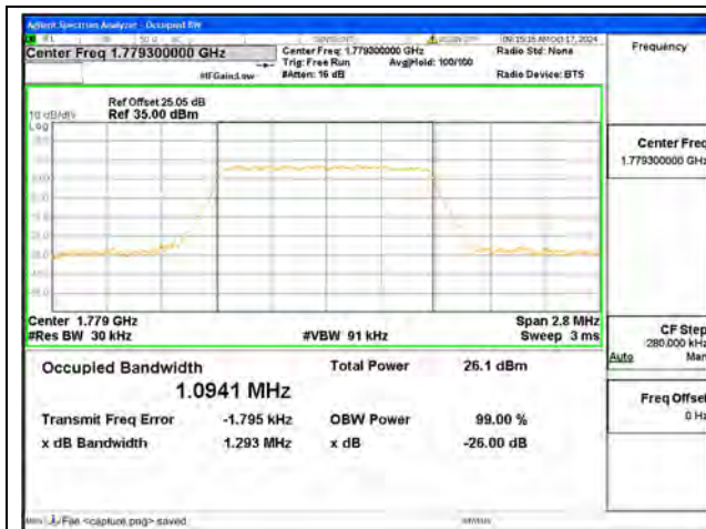
B66 / 1.4MHz / QPSK/ High CH
