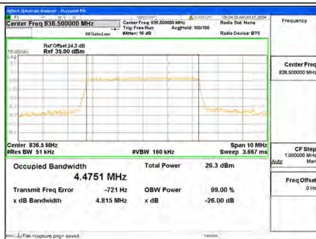
B5 / 5MHz / 64QAM/ Mid CH
