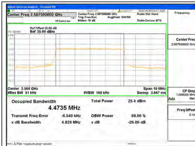
B7 / 5MHz / QPSK/ High CH
