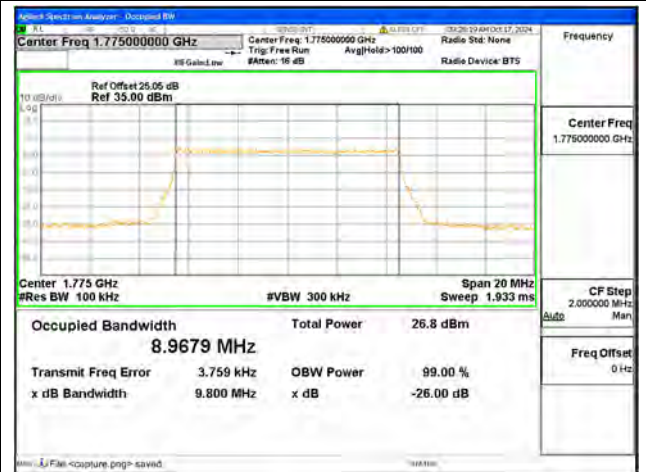
B66 / 10MHz / QPSK/ High CH
