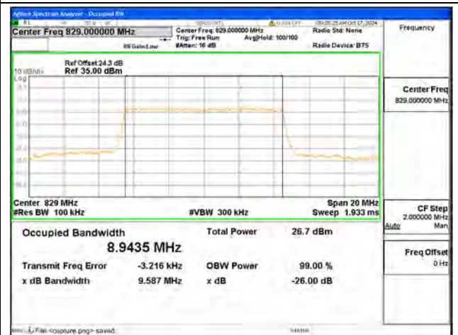
B5 / 10MHz / 64QAM/ Low CH
