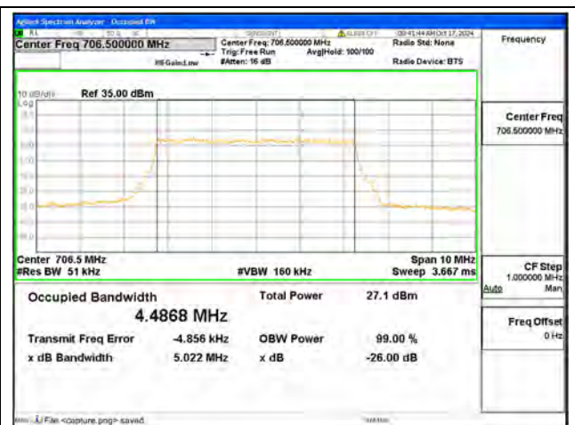
B17 / 5MHz / 16QAM/ Low CH
