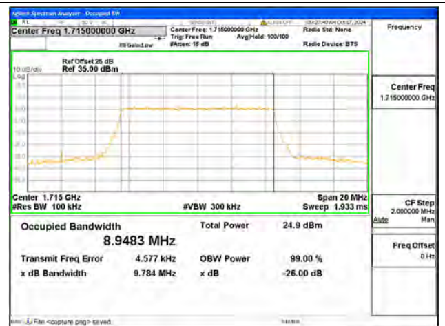
B66 / 10MHz / 64QAM/ Low CH
