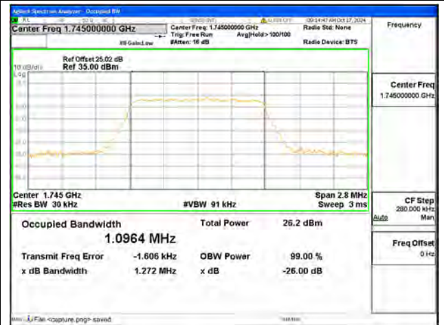
B66 / 1.4MHz / QPSK/ Mid CH
