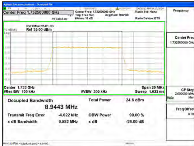
B4 / 10MHz / 64QAM/ Mid CH
