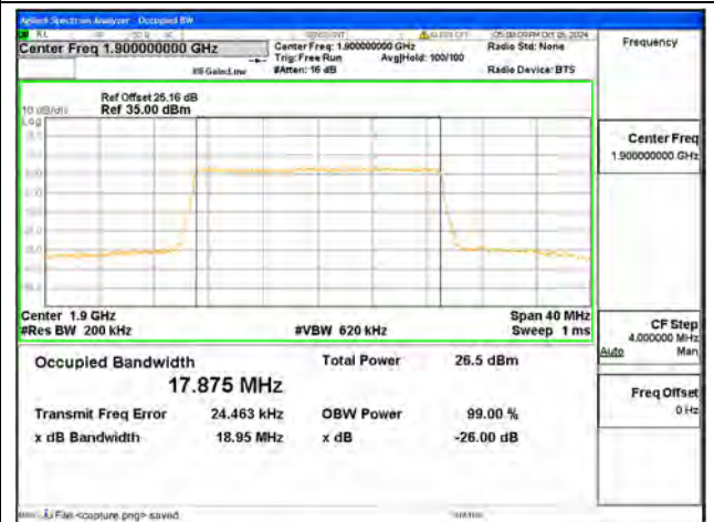
B2 / 20MHz / QPSK/ High CH
