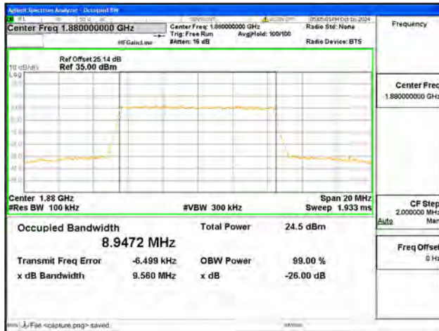
B2 / 10MHz / 64QAM/ Mid CH
