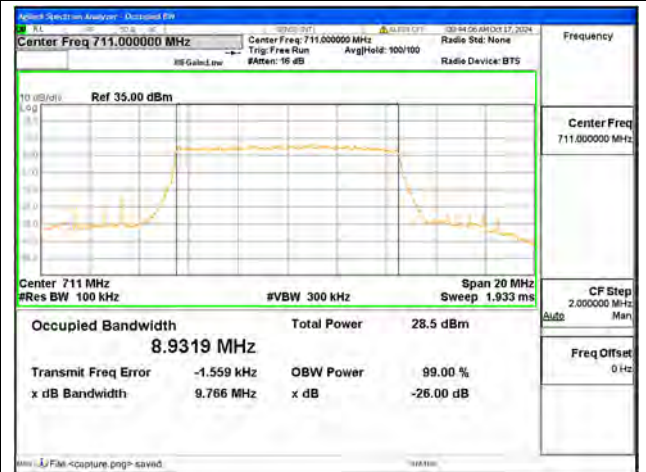
B17 / 10MHz / QPSK/ High CH
