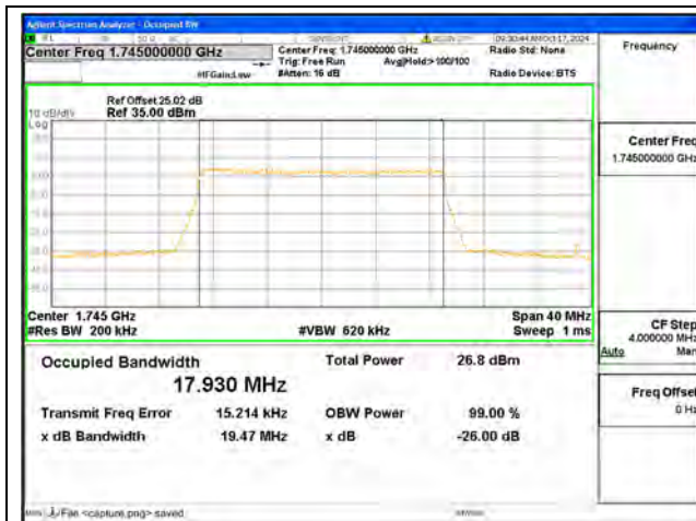
B66 / 20MHz / QPSK/ Mid CH
