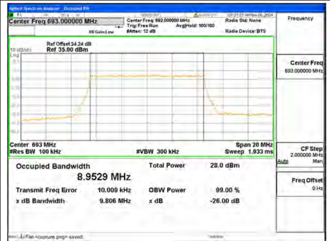
B71 / 10MHz / QPSK/ High CH
