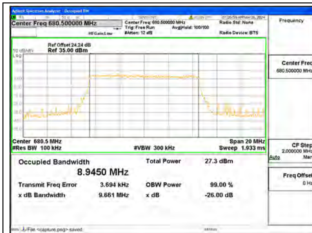
B71 / 10MHz / QPSK/ Mid CH
