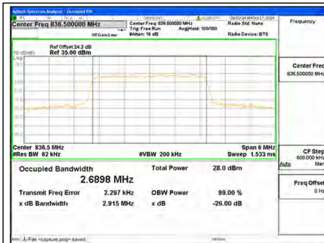
B5 / 3MHz / QPSK/ Mid CH
