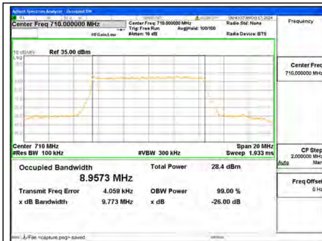
B17 / 10MHz / QPSK/ Mid CH
