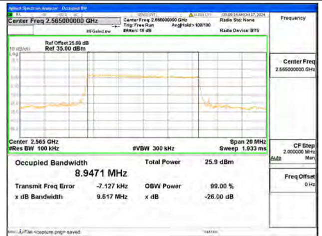
B7 / 10MHz / QPSK/ High CH
