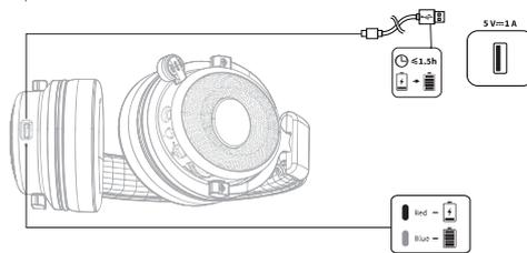
(1) Wenn der Headset-Akku niedrig ist, wird alle 3 Minuten eine Spracherinnerung "Schwache Batterie, bitte aufladen" durchgeführt und das rote Licht blinkt alle 3 Sekunden.
