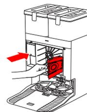
3. Insérez le haut du couvercle de la cabine de dépoussiérage dans la rainure et appuyez dessus pour vous assurer qu'il est fermé.
